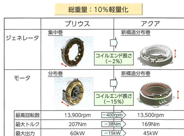
図8 ジェネレータ及びモータ比較
