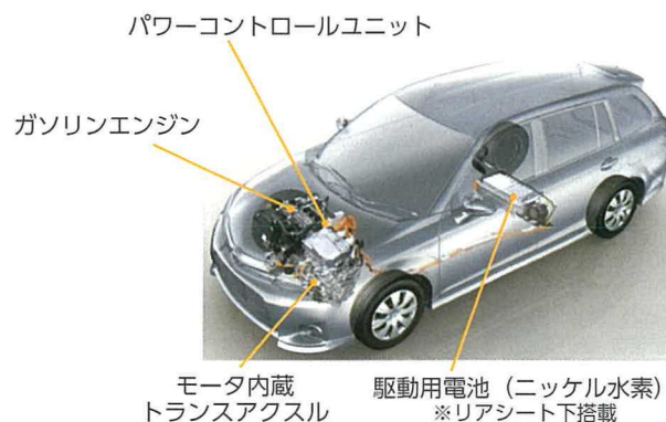
図1 カローラに搭載されるハイブリッド車用ユニット・搭載位置
