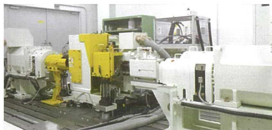
図18 HVシステム効率ベンチの外観
