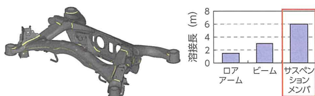
図1 リアサスペンションメンバと溶接長
